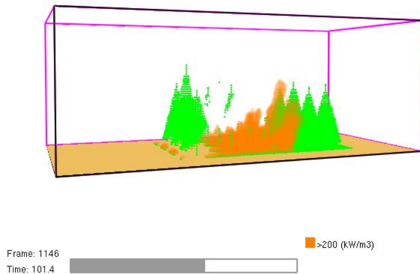
Рисунок 3.17– Візуалізація результатів моделювання пожежі соснових молодняків у програмі Smokeview із завантаженими частками Лагранжа, які формують структуру горючого матеріалу
