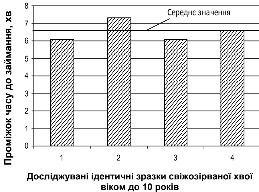
Рисунок 3.6 – Значення проміжку часу до займання свіжозірваної хвої сосни звичайної у молодому віці, визначені за результатами експериментальних досліджень
