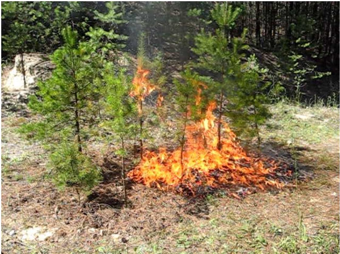
Рисунок 3.11 – Загальне фото процесу розповсюдження експериментальної пожежі на штучно сформованій ділянці соснових насаджень віком до 10 років на 62-ій с від початку горіння з переходом низової пожежі у верхову
