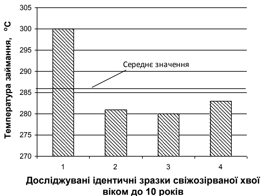
Рисунок 3.5 – Значення температури займання свіжозірваної хвої сосни звичайної у молодому віці, визначені за результатами експериментальних досліджень
