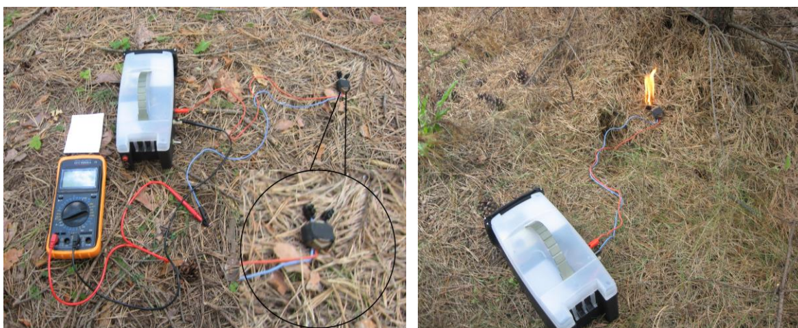
Рисунок 5.1 – Загальний вигляд процесу визначення температури та проміжку часу до займання у польових умовах з використанням розробленого пристрою
