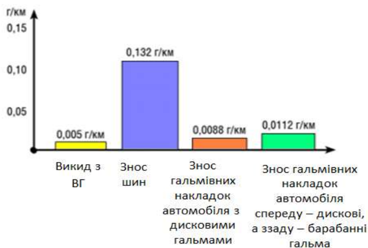
Рисунок 1.6 – Фактичні викиди ТЧ з ВГ при зносі шин і гальмівних накладок під час експлуатації легкових автомобілів, г/км [13]
