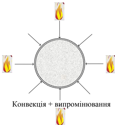
Рисунок 6 – Схема теплового впливу на ТБК
