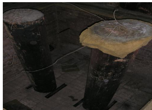
Рисунок 17 – Вигляд трубобетонних колон-зразків після проведення вогневих випробувань
