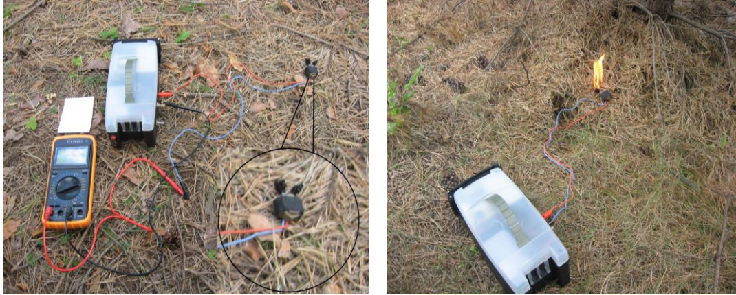
Рисунок 9 – Загальний вигляд процесу визначення температури займання та проміжку часу до займання у польових умовах з використанням розробленого пристрою
