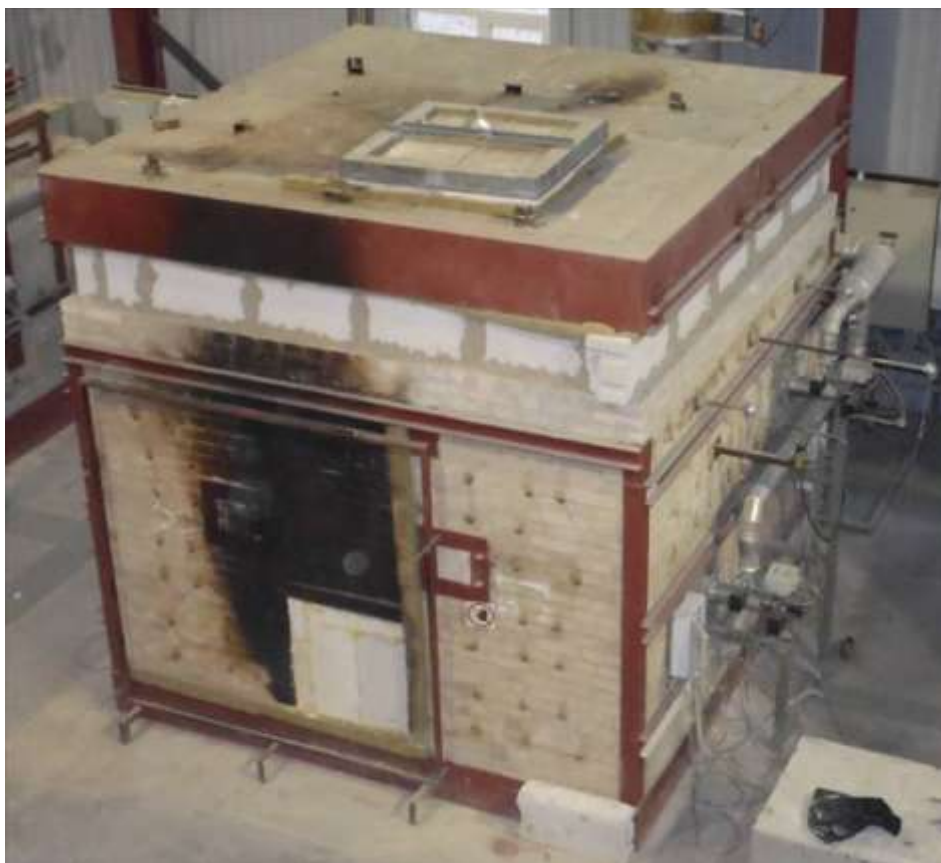
Рисунок 4.11. – Вигляд установки для випробування трубобетонних колон, готової до проведення експериментів
