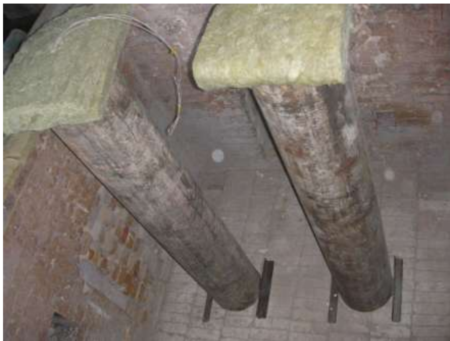
Рисунок 4.9 – Вигляд трубобетонних колон-зразків для випробувань
