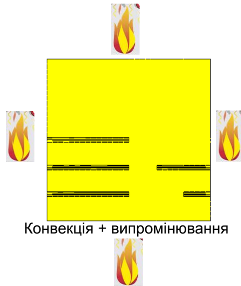
Рисунок 3.17 – Схема теплового впливу на зразок
