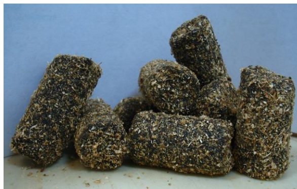
Рисунок 3.1 – Вид гранул, отриманих екструзійним методом
