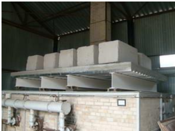
Рис. 1 Вигляд навантажень балок до початку випробувань
