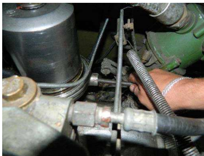
Рис. 14.3. Розбирання, промивка та установка масляного фільтру (центрифуги) двигуна ЗІЛ-131
