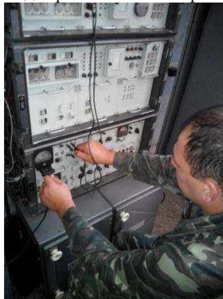
Рис.3.9 (б). Перевірка напруги джерела живлення і рівнів сигналів.
