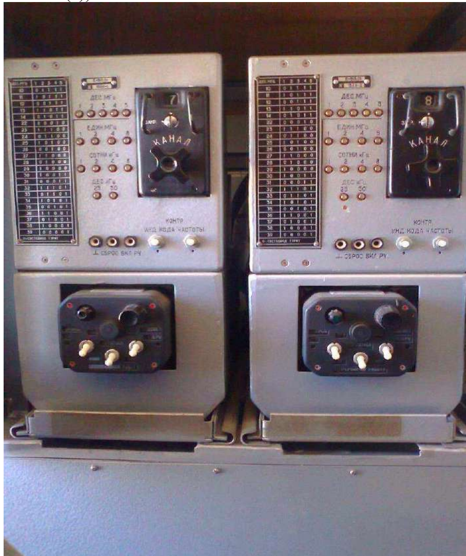
Рис. 3.15 (а). Налаштування приймача на двох фіксованих частотах. Вмикається контрольно-випробувальний генератор (КВГ) і проводиться від нього налаштування радіопеленгатора (рис. 3.15 (б)).
