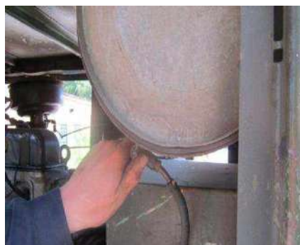
Рис .1.5. Подача палива до карбюратора двигуна
