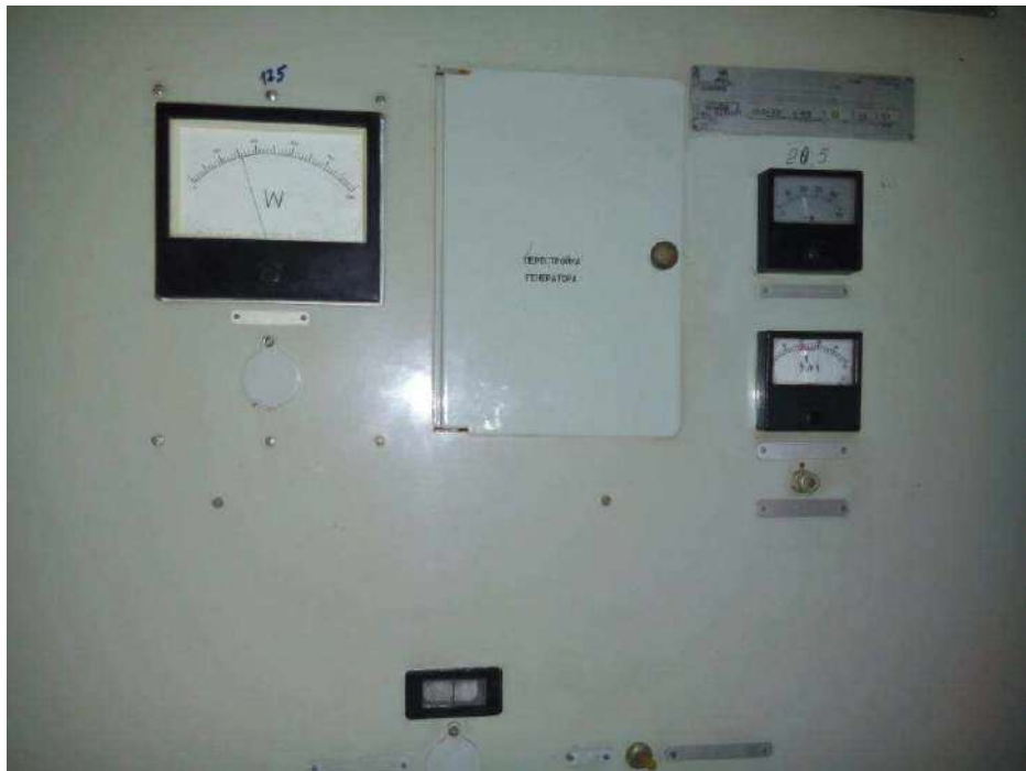
Рис. 3.21 (в). Перевірка потужності передавачів ДРЛ
