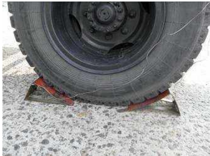
Рис.1.5 (в). Встановлення противідкатних колодок
