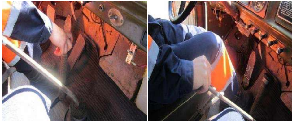
Рис. 7.2. Управління трансмісією та роздавальною коробкою
