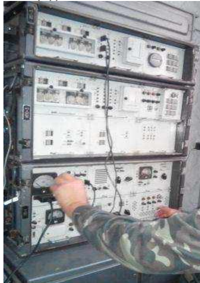
Рис.3.9 (а). Ввімкнення живлення Перевіряється напруга джерела живлення і рівні сигналів (рис.3.9 (б)).
