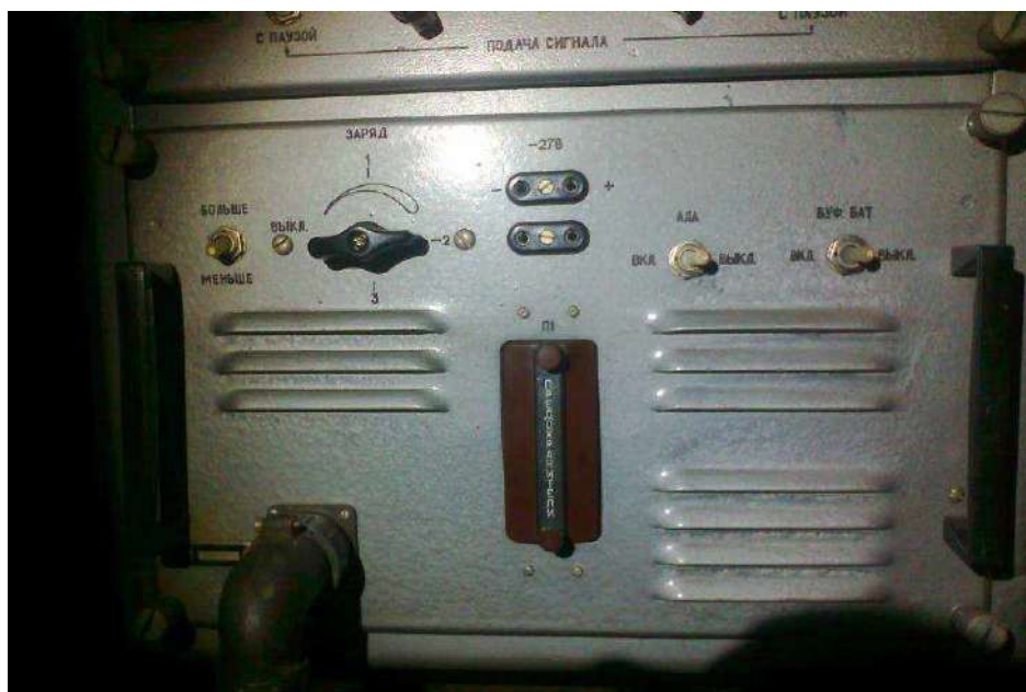
Рис. 3.17 (в). Вмикання радіостанції на силовому блоці
