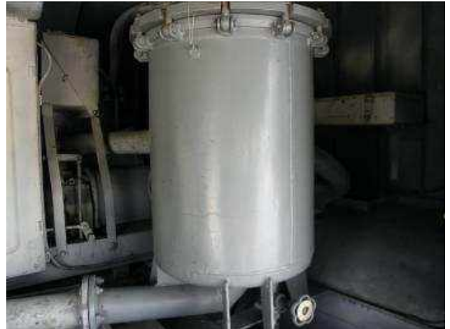
Рис.1.3(б). Огляд паливного фільтра спец. установки ТЗ-22 на наявність підтікання рідини
