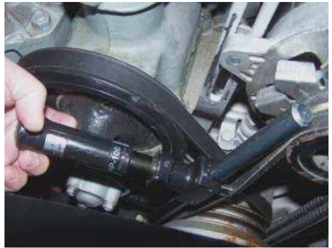
Рис. 21.2. Перевірка натягу за допомогою ППНР-100
