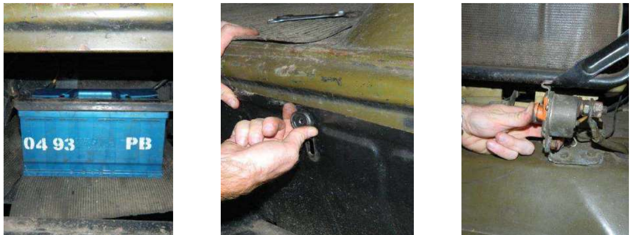
Рис. 13.4. Встановлення акумуляторних батарей
