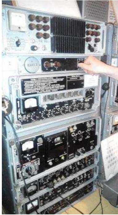
Рис. 3.2 (б). Налаштування приймача на дві частоти із запам'ятовуванням
