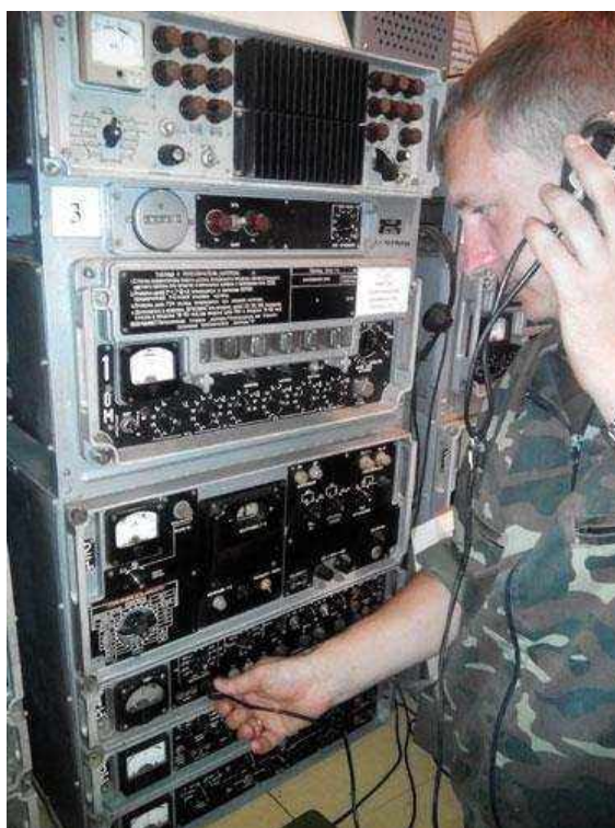
Рис. 3.1 (в). Перевірка працездатності приймача в слухових режимах за сигналами станцій, що приймаються радіоприймачем Р-155П.
