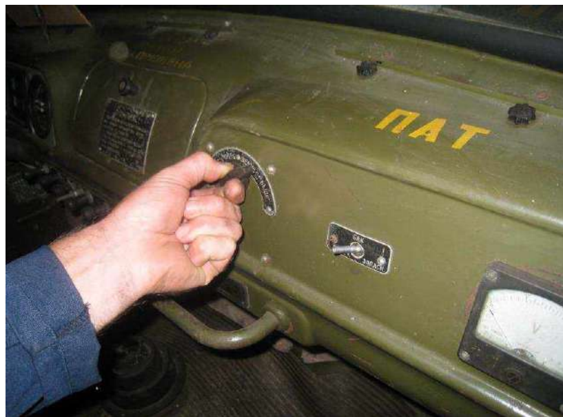
Рис.3.23 (а). Встановлення напруги 110В
