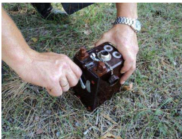
Рис. 4.3.4. Перевірка підривної машинки
