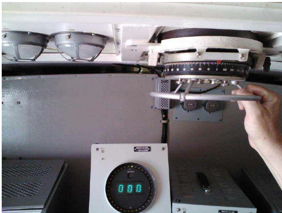
Рис. 3.15 (б). Налаштування радіопеленгатора від КВГ
