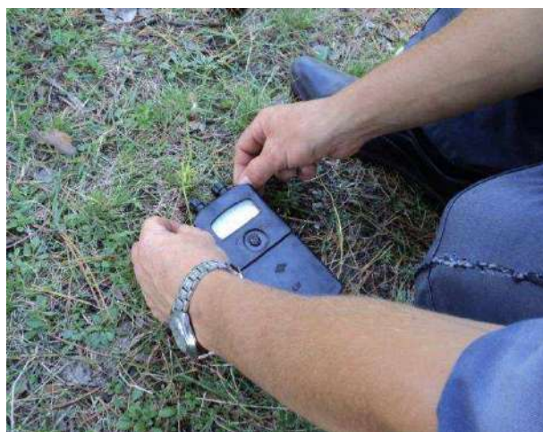
Рис. 4.3.3. Перевірка електропровідності електродетонатора
