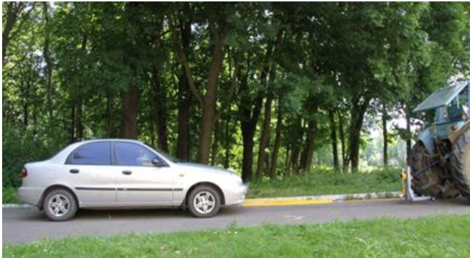
Рисунок 1 - Пристрій для дослідження коефіцієнта опору коченню: a – схема; б – загальний вигляд; в – фрагмент випробування
