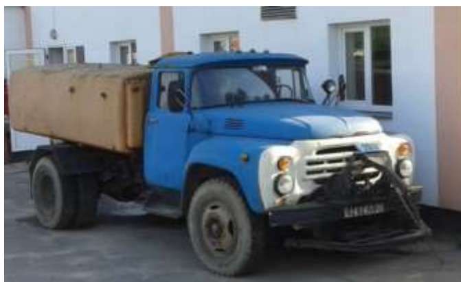
Рисунок 1.5 – ПМ-130 із навісним обладнанням для гідропосіву сміттєзвалищ
