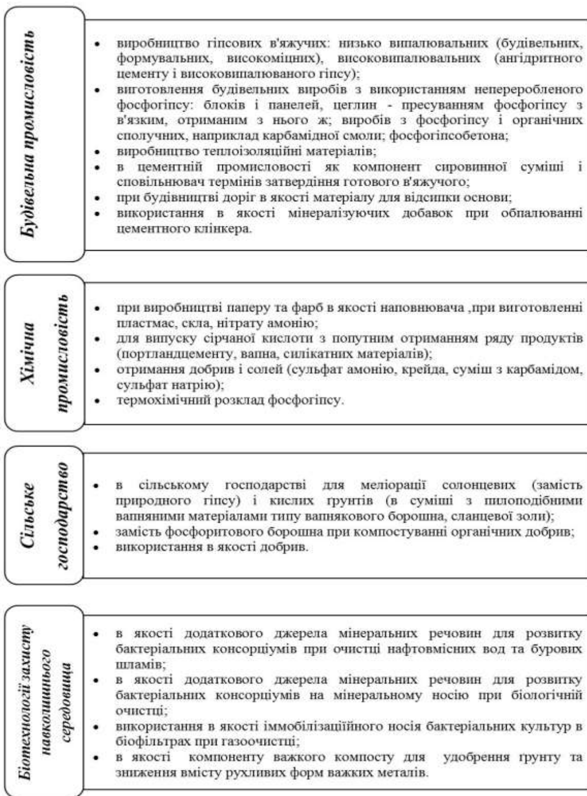
Рисунок 1.1 – Блок-схема напрямків утилізації та переробки фосфогіпсу
