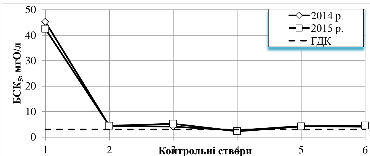
Рисунок 9.2 - Профілі зміни БСК 5 у Західному Бугу в границях Львівської області в 2014 і 2015 роках.
