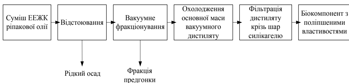
Рис. 2.3. Схема вакуумної дистиляції
