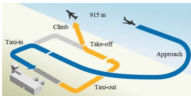
Рис. 3.6. Еталонний злітно-посадковий цикл
