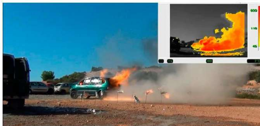
Рисунок 20 – Приклад горіння водню в АВП та його зображення на моніторі пожежного тепловізора
