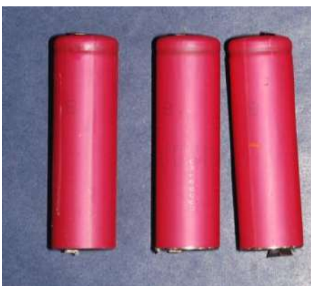
а) приклад елемента живлення зразка 18650 (18 x 65 мм)
