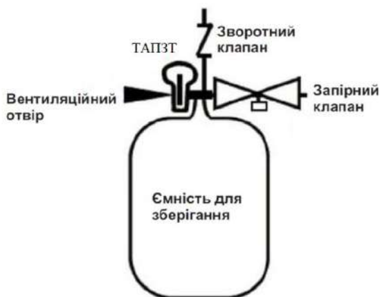
Рис. 12. Схематичне зображення балона для зберігання водню з системами безпеки
