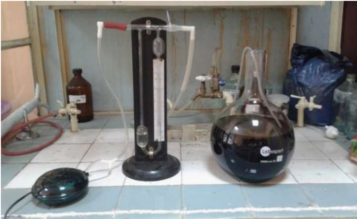
Рис. 2.8. Схема експериментальної установки для дослідження аеробного очищення інфільтрату.
