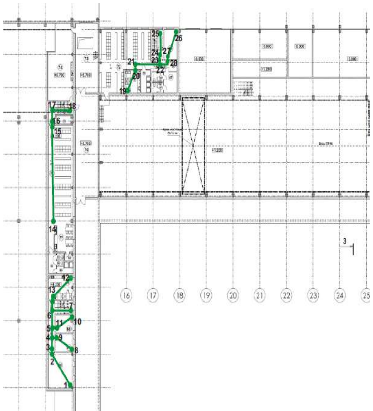
Рис. 9. Розрахункова схема евакуації людей з позначки +4.200 через сходи на позначку +1.200 до моменту злиття із потоком людей, які евакуюються із позначки +1.200
