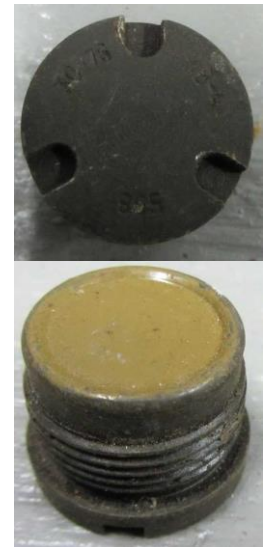
Рис. 1.9 – КВ-4 (54-К-001) вагою 69,0 г: 1 – корпус із Ст.15 = 58,0 г; 2 – КЗ 54-К-001; 3 – притискна втулка із ЛС-60; 4 – наковаленка із ЛС-60; 5 – порохова підсипка з ДРП-2Пр = 0,6 г.; 6 – порохова петарда з ДРП-3 = 3,1 г.; 7 – обтюруючий конус ЛС-60; 8 – пергаментний кружок; 9 – латунний кружок ЛС-60; 10 – паперовий кружок; 11 – лак-мастика; діаметр різьби \varnothing 27 мм (всього ЛС-60 = 4,17 г.)
